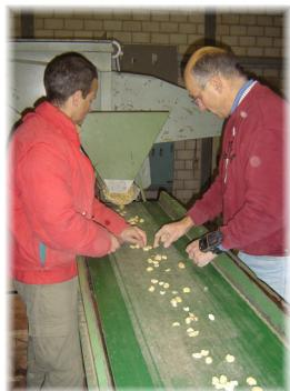
Una volta secche, si procede alla sbucciatura. Questa operazione è svolta con l'ausilio di una speciale macchina sbucciatrice.
